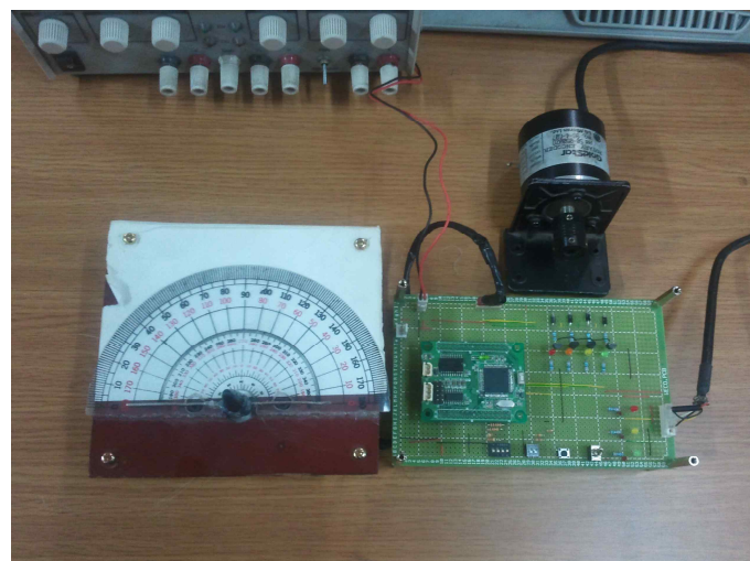
그림 1.1.2 증분식 엔코더 및 스텝 모터 실험 세트
