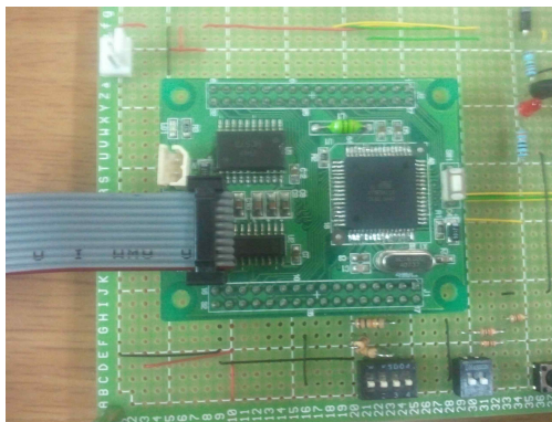
그림 1.1.6 USB-ISP와 Atmega128 module 연결 모습
