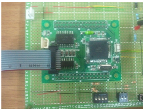
그림 1.1.6 USB-ISP와 Atmega128 module 연결 모습
