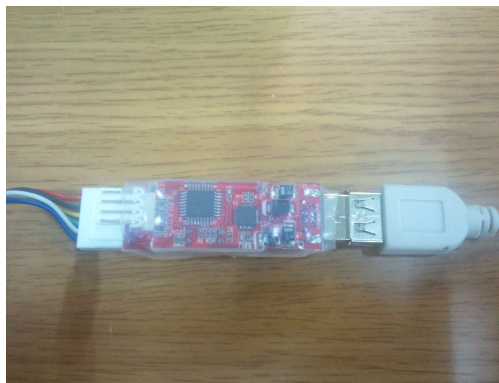
그림 1.1.7 USB-ISP와 IBM-PC와 연결 모습
